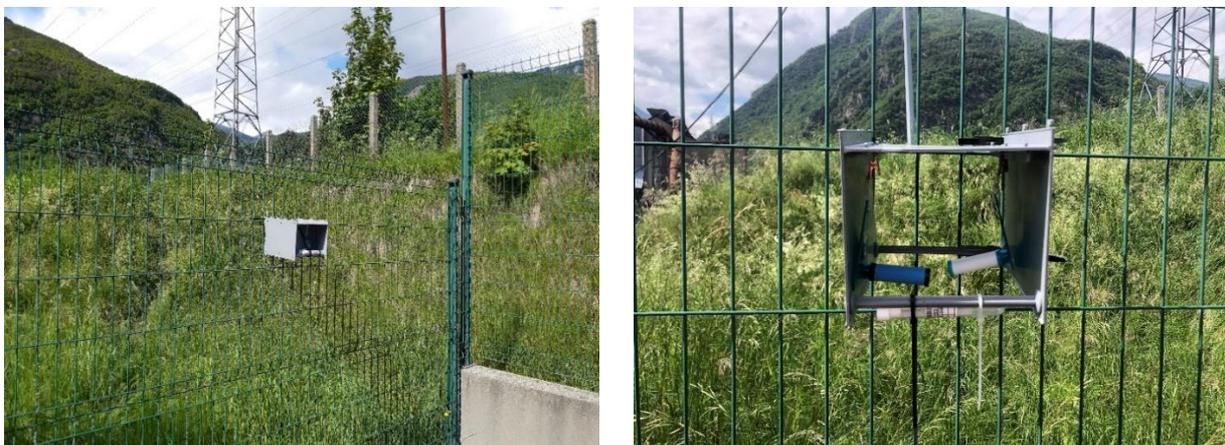
Figure 11 : Illustrations des équipements de prélèvement passif par Radiello
