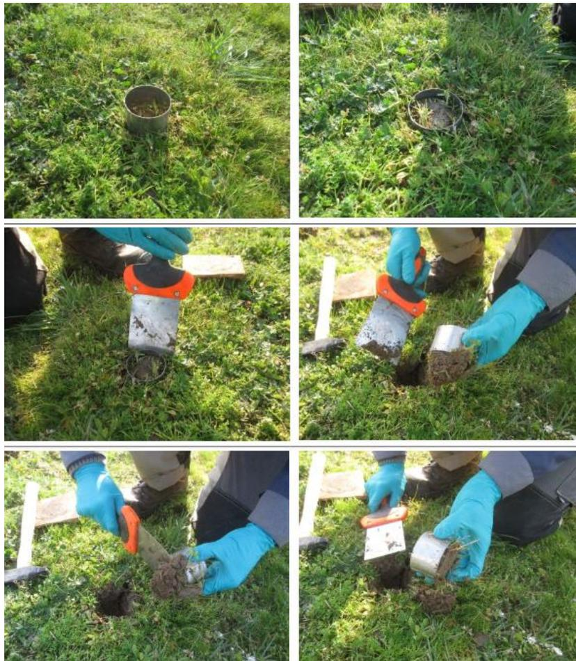
*Figure 17 : Méthodologie de prélèvement des sols superficiels*
