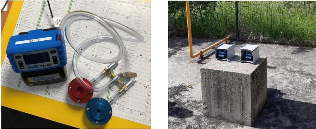
Figure 10 : Illustrations des équipements de prélèvement par pompe bas débit avec un dispositif multivoies
